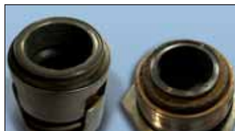
Рис. 5.12. Глубокие борозды на поверхности уплотнения со стороны перекачиваемой жидкости
