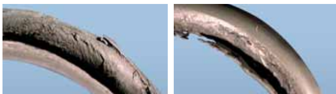
Рис. 5.19. Выдавленные высоким давлением уплотнительные кольца
