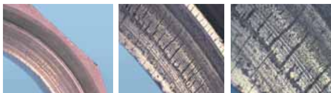
Рис. 5.4. Сильное термическое растрескивание поверхности уплотнения из WC, вызванное недостаточной смазкой
