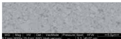
Рис. 3.6. Микроснимок вытравленной поверхности карбида вольфрама
