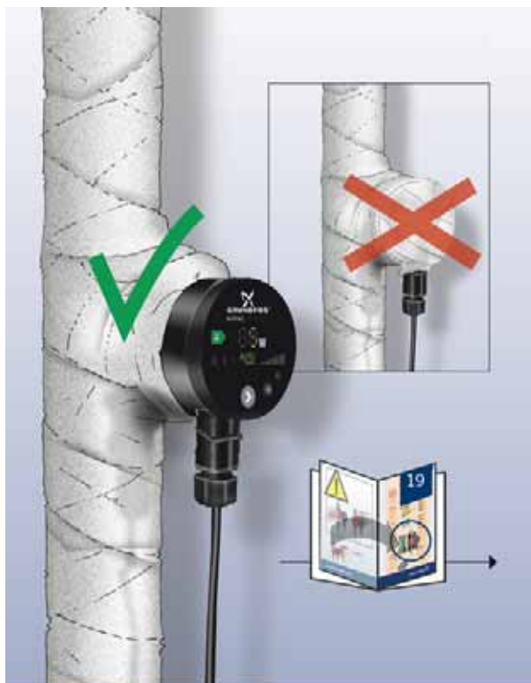
Рис. 5 Изоляция корпуса насоса
